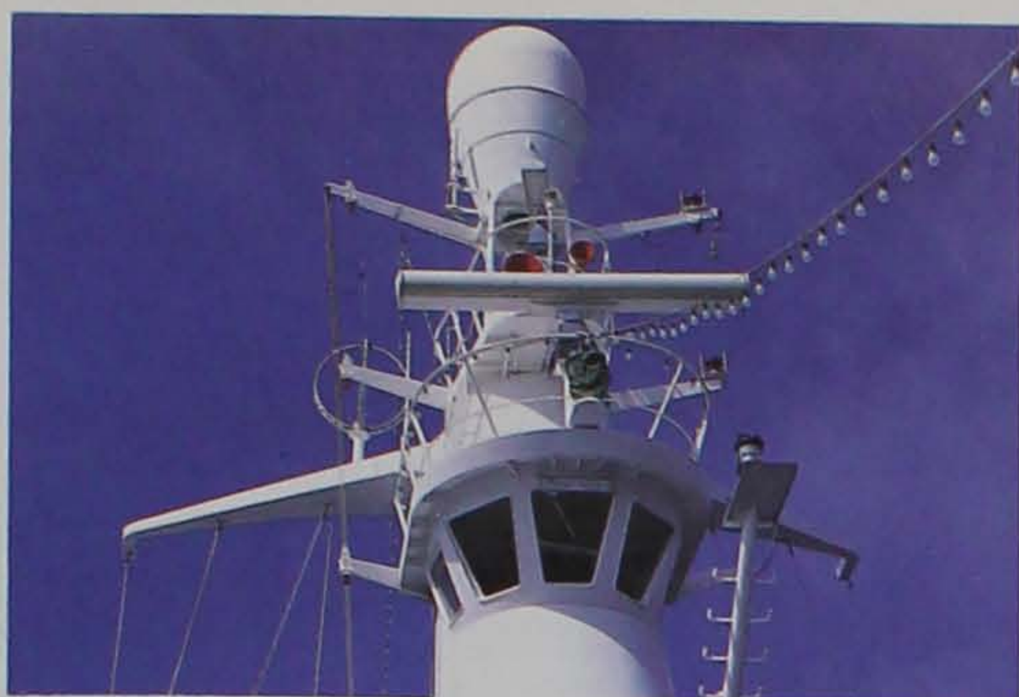
Вращающаяся антенна локатора находится ниже красных рожков судовой сирены.
