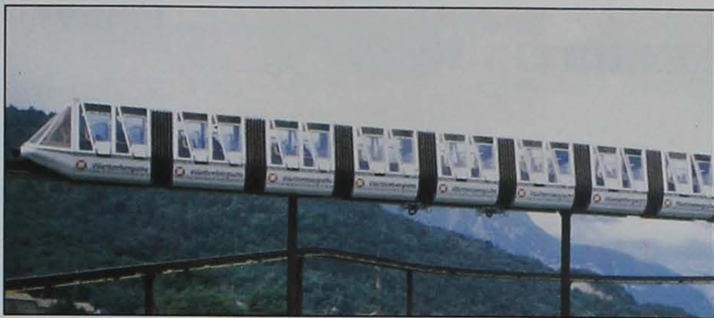
Обычная монорельсовая дорога. Монорельсовый поезд седлающего типа с 18 автоматическими вагонами в немецком городе Штутгарт движется по дороге длиной в 3 мили.
