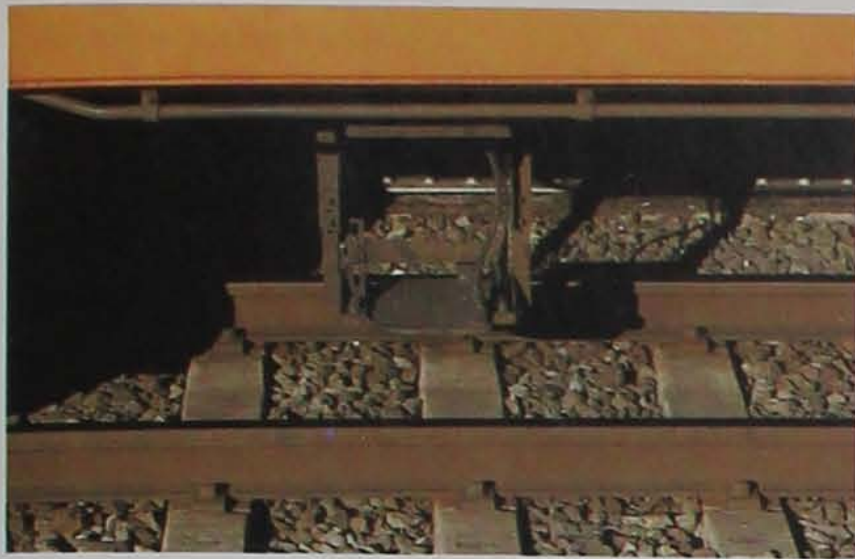
Поездной автостоп , установленный под железнодорожным вагоном, сам включит тормоза, если не получит разрешающего сигнала от передатчика, установленного на путях.
