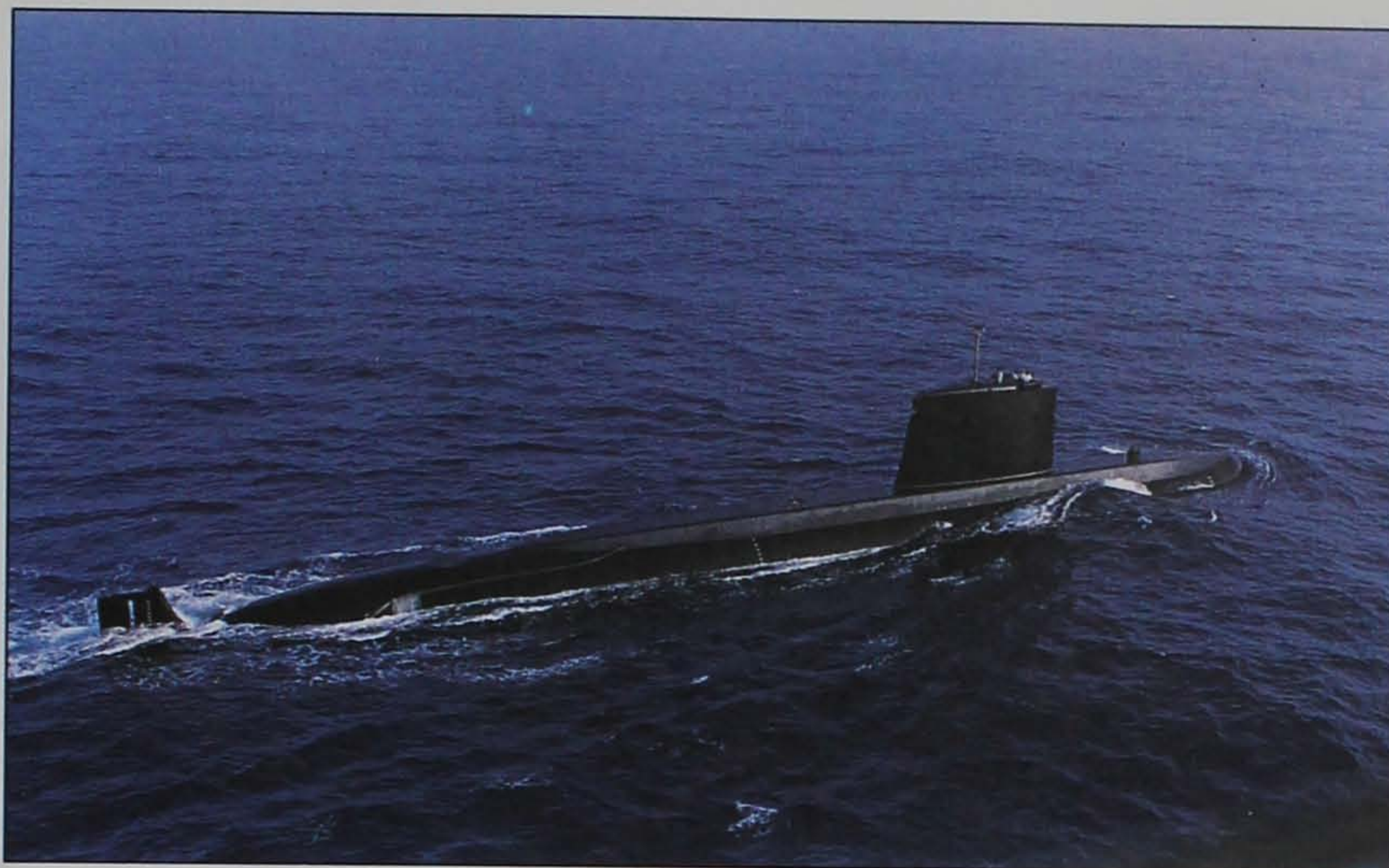
Атомная подлодка курсирует вдоль побережья в надводном положении. Таким кораблям надо пополнять топливо лишь один раз в два-три года.
