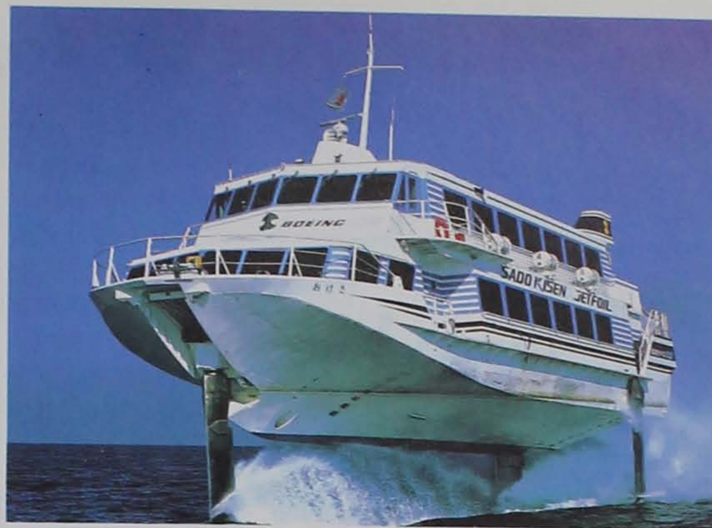
Стойки выпущены, когда судно на подводных крыльях идет по морю.
