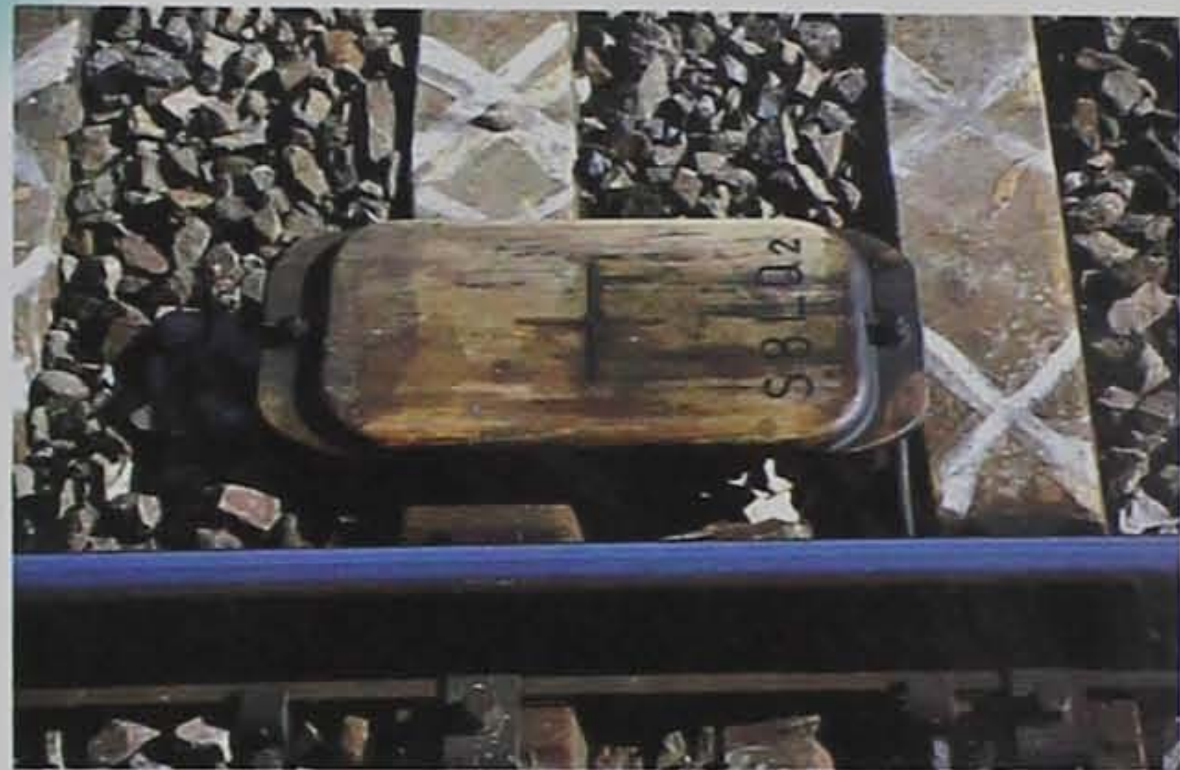
Передатчик сигналов прикреплен к рельсовому пути.
