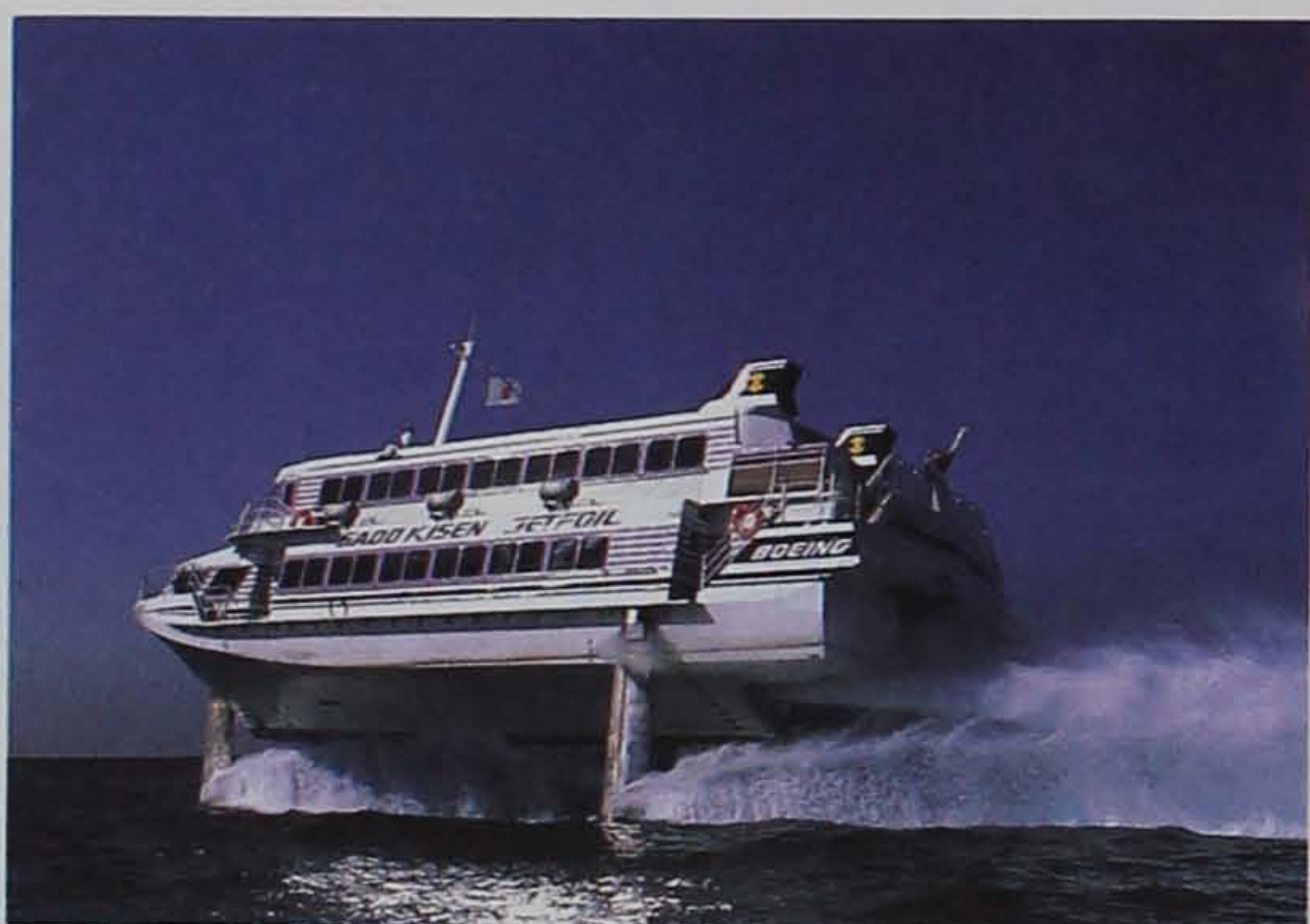
Мощные насосы двигают вперед судно на подводных крыльях.
