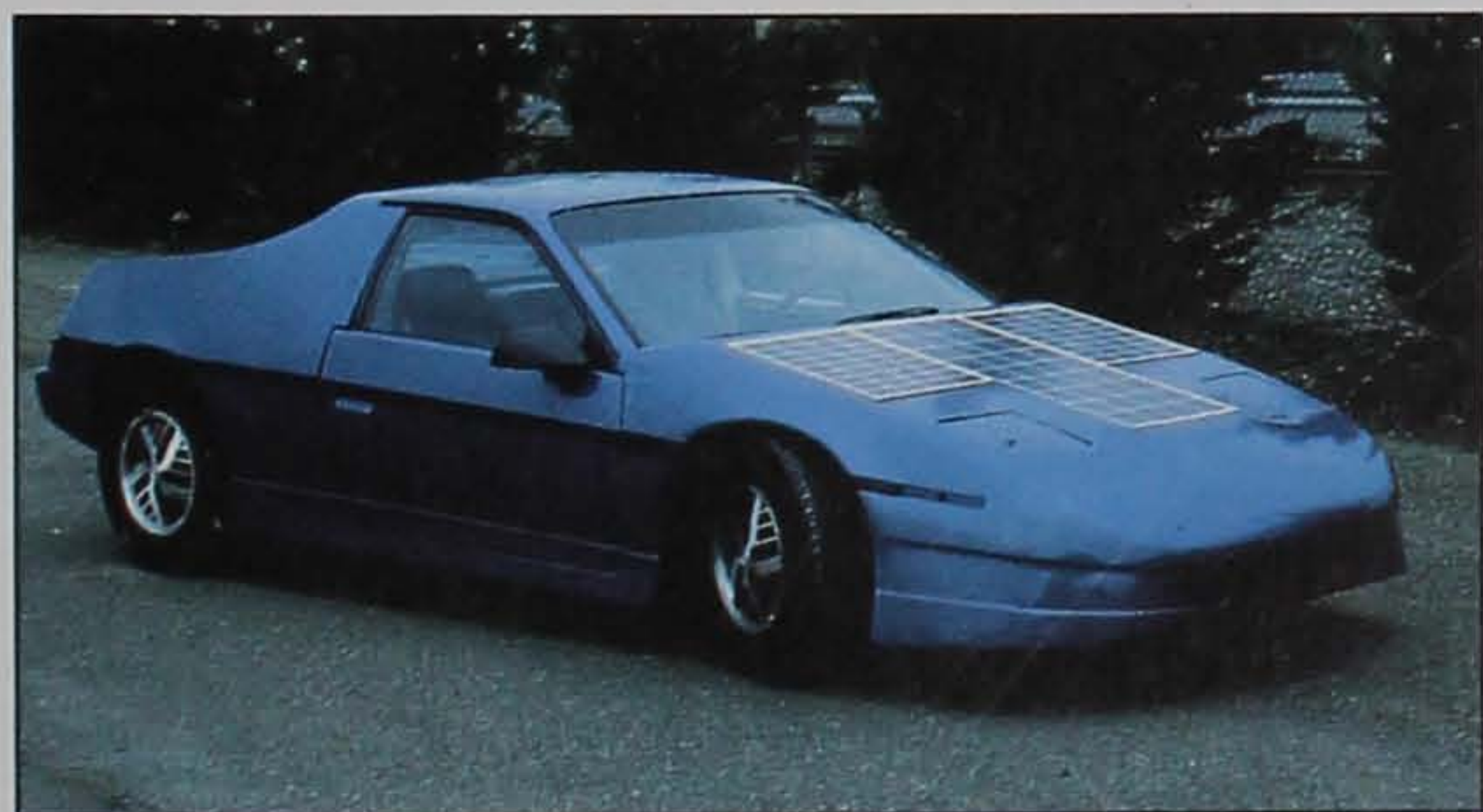
В модели электромобиля "Дестини 2000" сочетается применение солнечных панелей и аккумуляторов с кузовом из стекловолокна.
