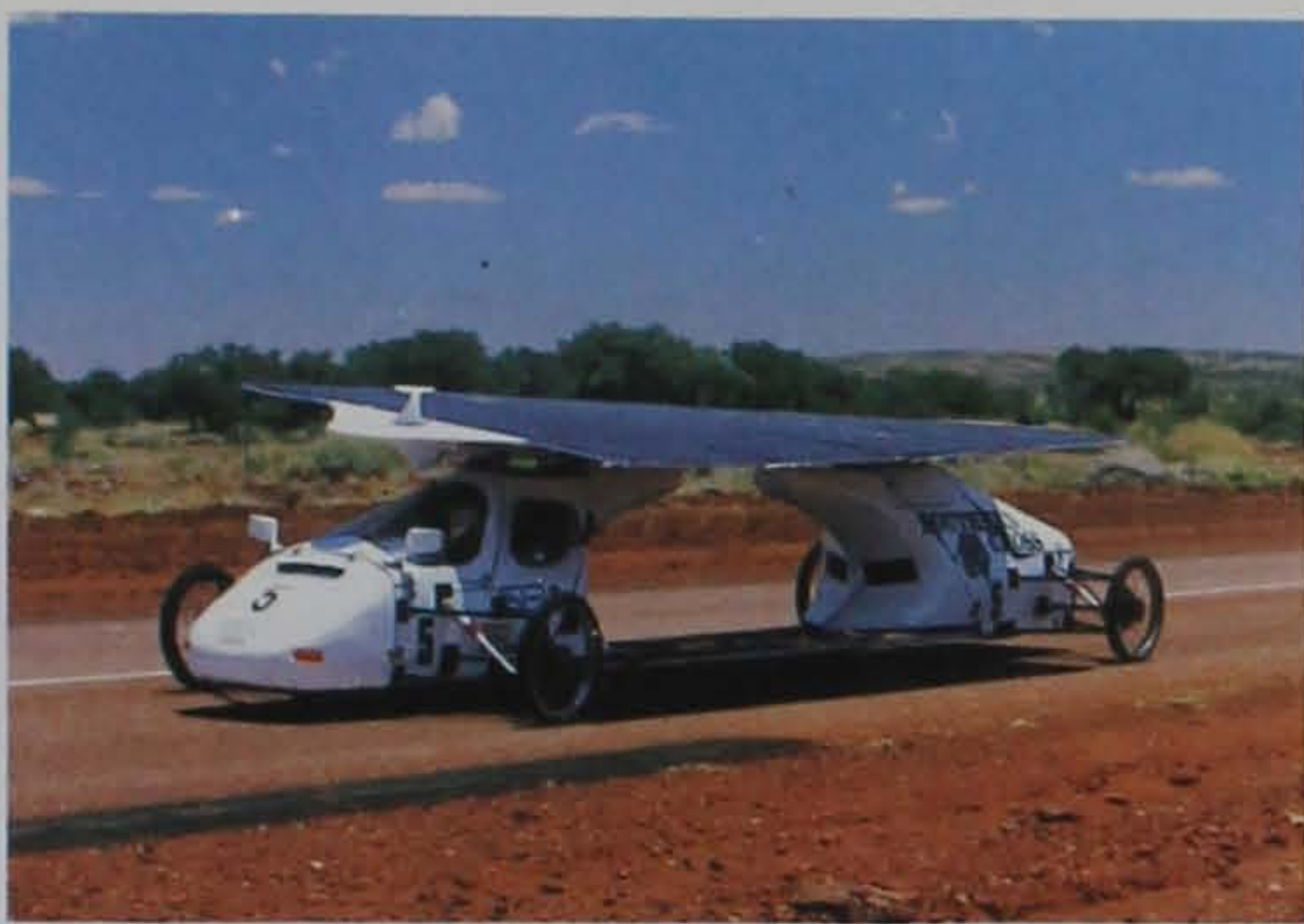
“Саузен кросс” имеет наклоняемую солнечную панель.
