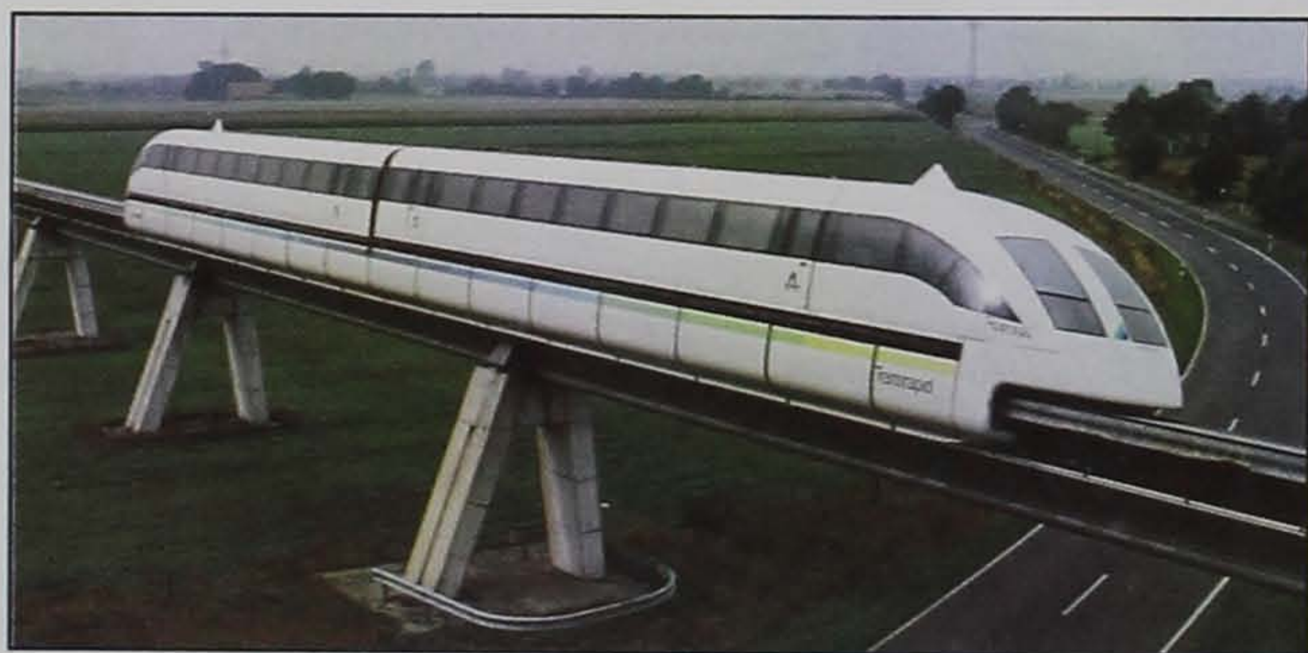
Поезда на магнитной подвеске, курсирующие в Германии, получили название “Трансрепид”. Они имеют стреловидную форму и устроены так, что вкруговую охватывают вознесенный на опорах направляющий рельс.
