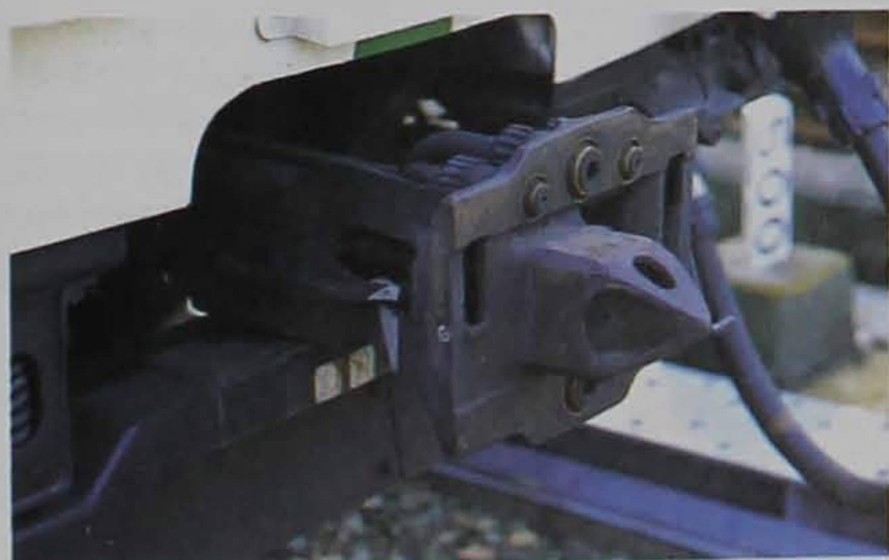
Контактная сцепка обычно применяется в метропоездах и поездах наземной железной дороги, проложенной по эстакаде.
