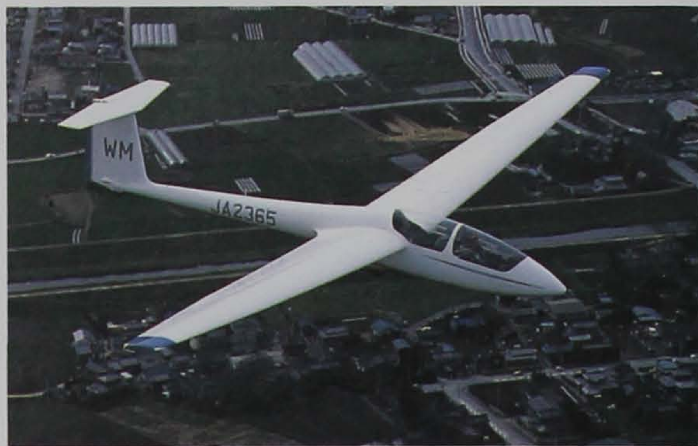
Стройный парящий планёр имеет узкий фюзеляж и длинные крылья, позволяющие получить подъемную силу больше чем у самолетов, оснащенных мощным двигателем.
