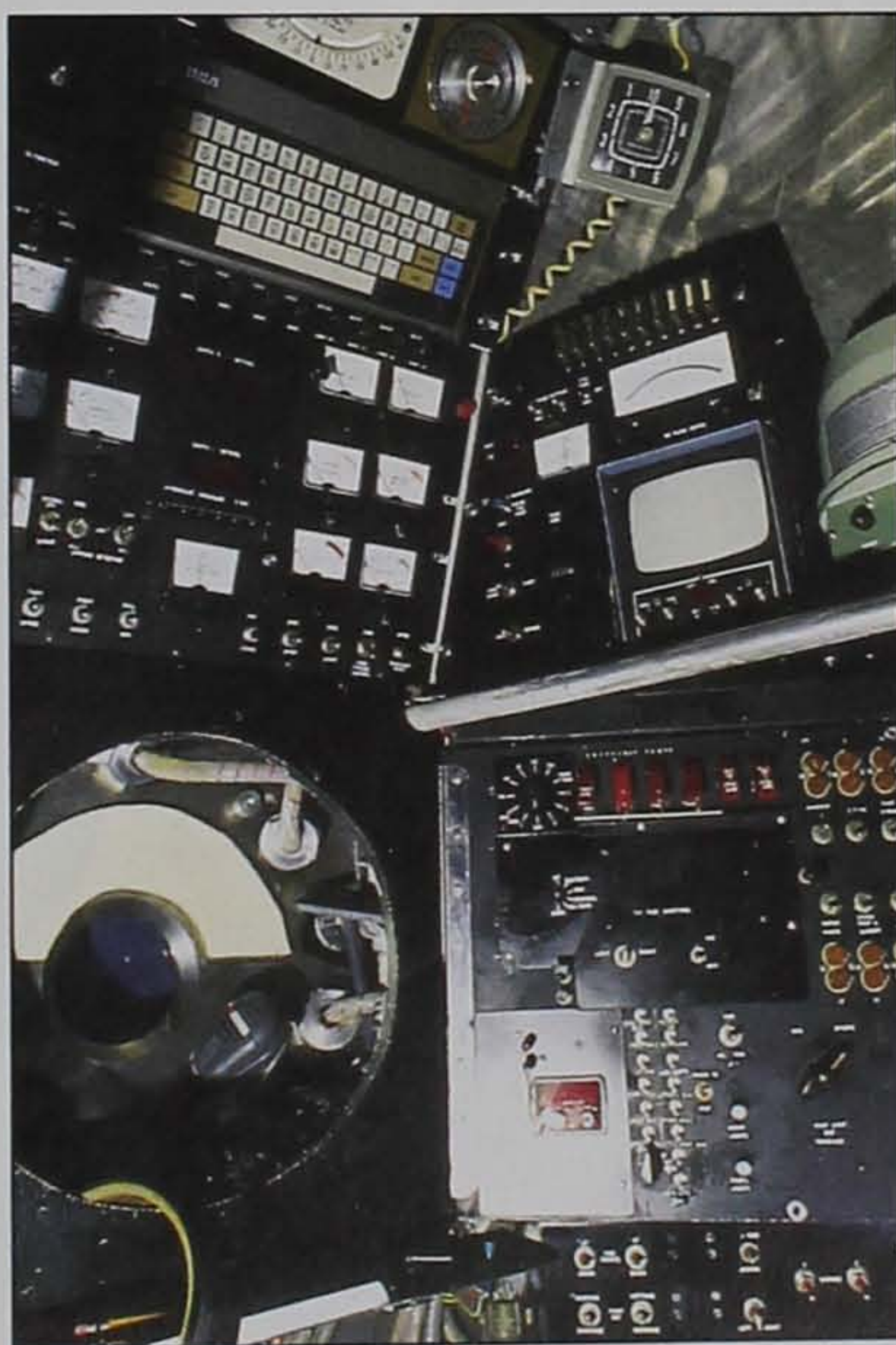
Внутреннее убранство тесного отсека управления на батискафе "Элвин" связано с различными приборами.
