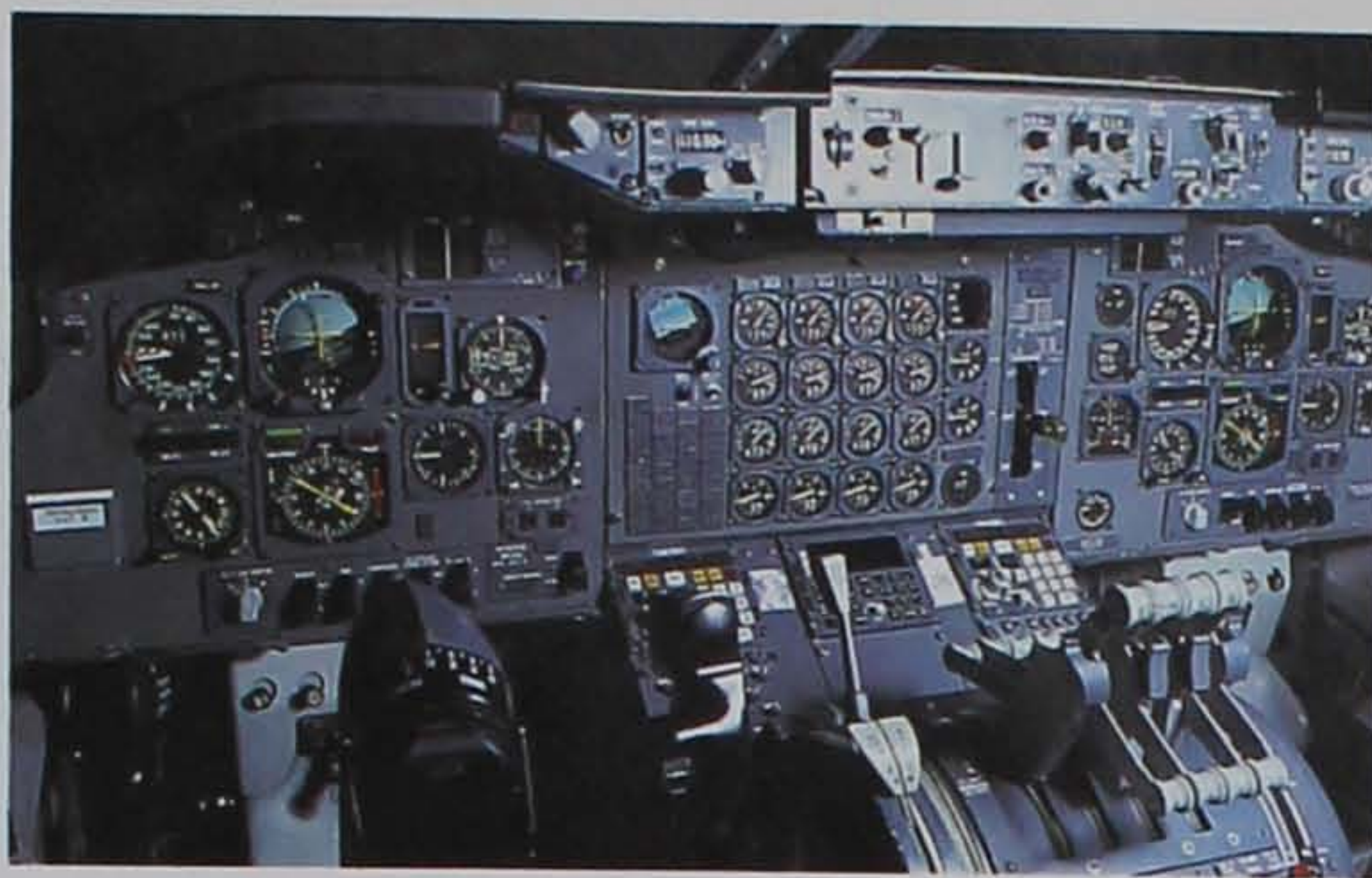
На приборной панели в кабине пилота расположено оборудование СПП и командный пилотажный прибор.
