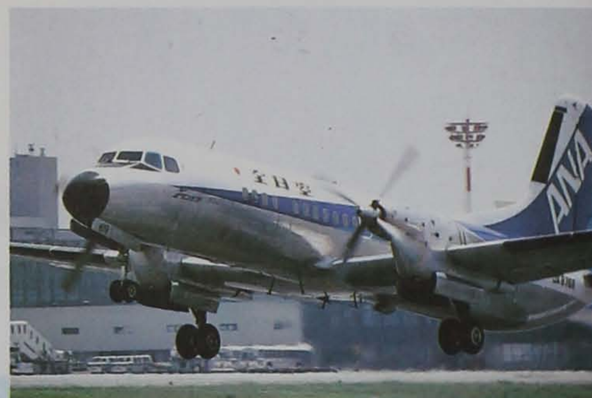
Винтовой самолет взлетает в воздух благодаря силе тяги, создаваемой при вращении лопастей воздушного винта.
