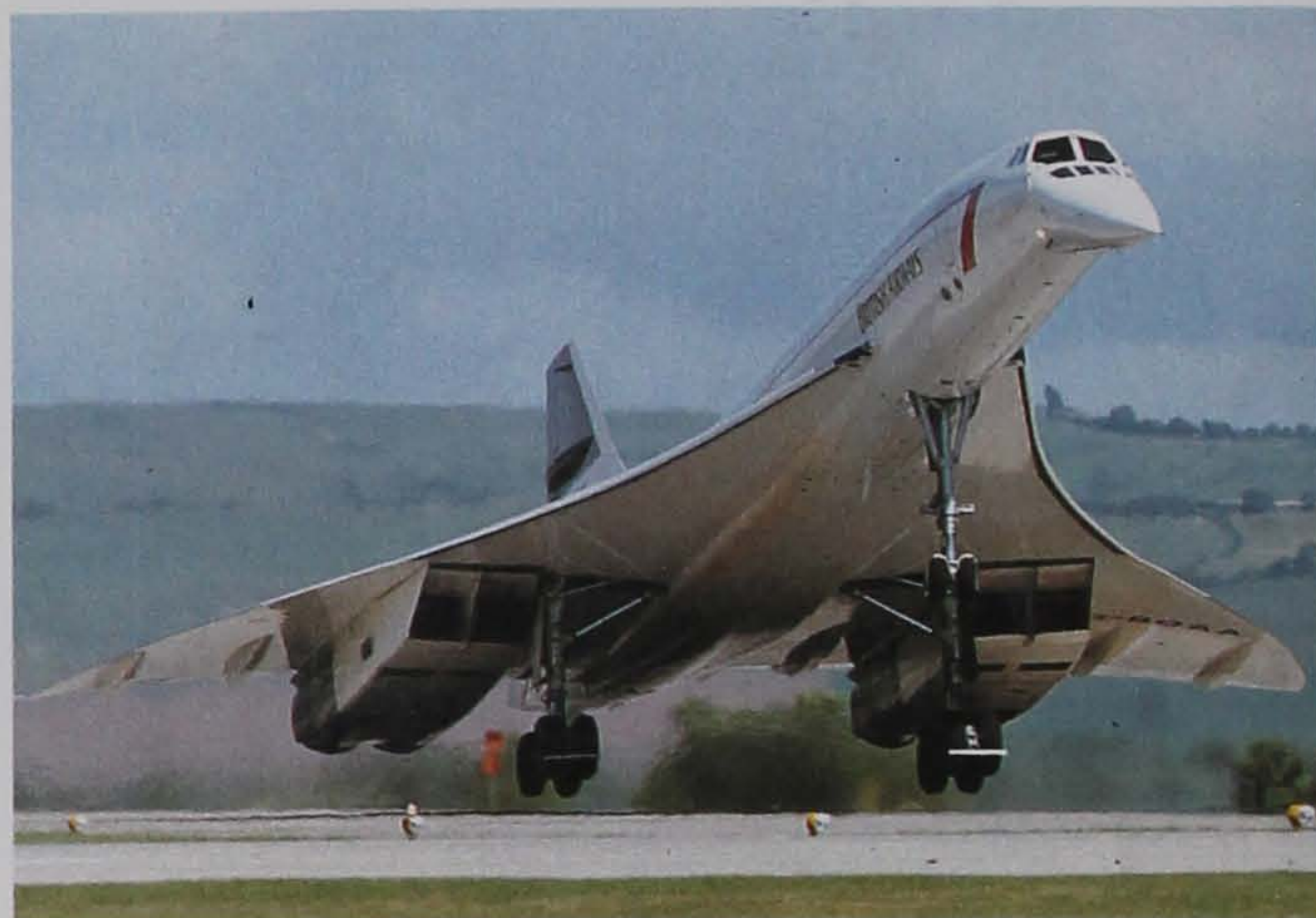
"Конкорд" на взлете. В это время его нос наклонен книзу.
