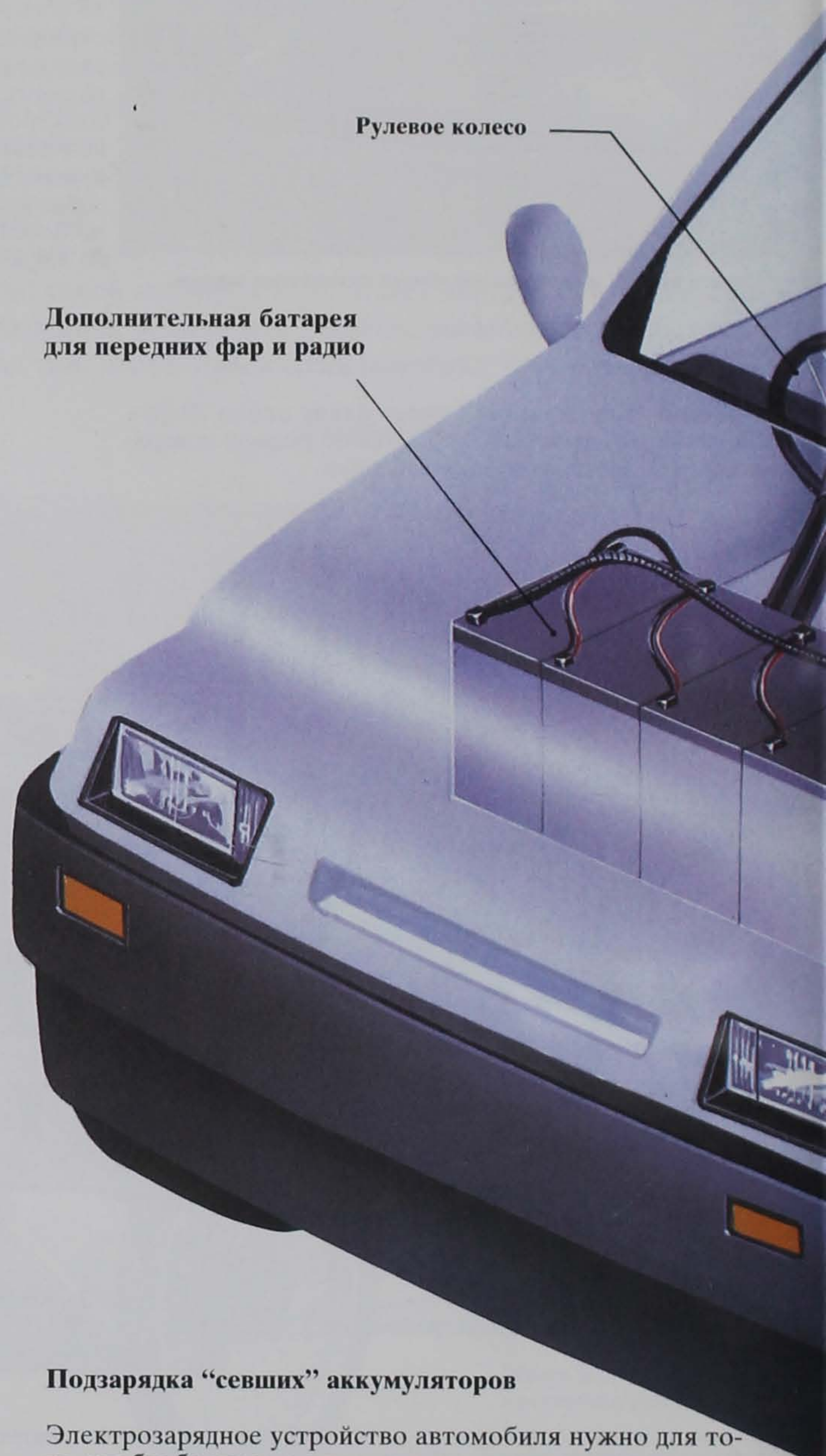
Схема устройства электро мобиля
