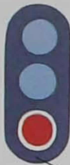
Красный сигнал трехцветного светофора предупреждает, что рядом впереди — другой поезд.
